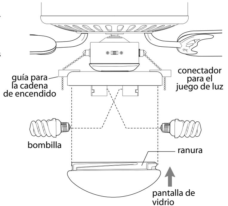
**Si desea utilizar el ventilador SIN el juego de luz**, quitar la tuerca hexagonal y la arandela de seguridad de la varilla roscada en la parte superior del conector para el juego de luz. Destornillar la cubierta de la caja de encendido para quitarla del conector para el juego de luz y cuidadosamente pasar los cables **AZUL** (o **NEGRO**) y **BLANCO** (uno por uno) del conector para el juego de luz por el agujero de en medio de la cubierta de la caja de encendido.
